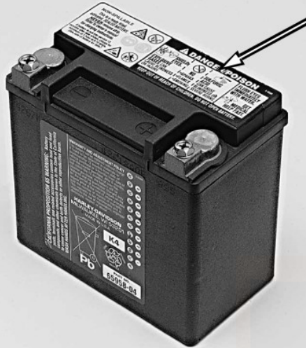
Figur 69. Advarselmærkat på batteri
