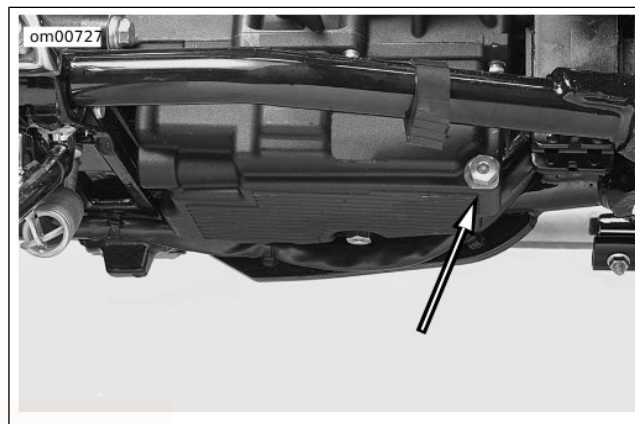
Figur 24. Motorens olieaftapningshane (bundkar under transmission, set fra køretøjets venstre side)
