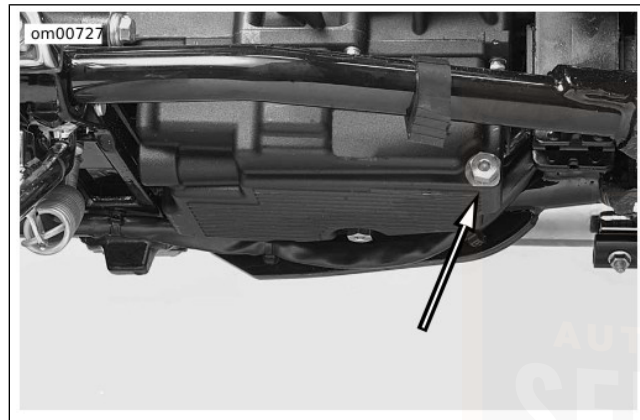
Figur 23. Motorens olieaftapningshane (bundkar under transmission, set fra køretøjets venstre side)
