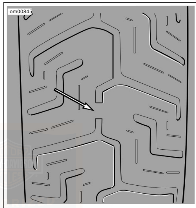
Figur 38. Tilsynekomst af Dunlop dækslidbane AFBALANCERING AF MOTORCYKLEN
