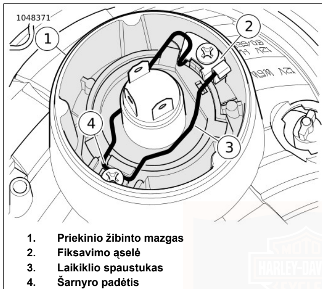
Pav 56. Priekinio žibinto laikiklio spaustukas, užrakintas
