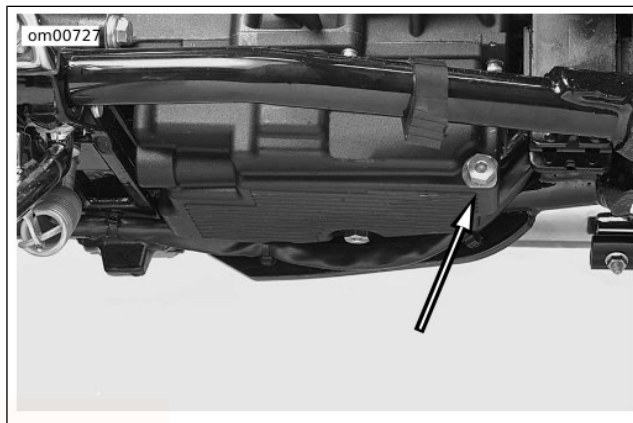
Figur 25. Oljereineringsplugg (oljepanne under girkasse, sett fra kjøretøyets venstre side)
