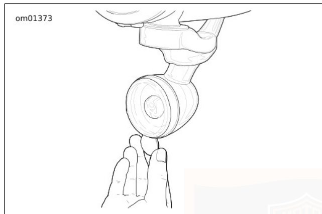
Slika 85. Zareza na pokrovu leče
