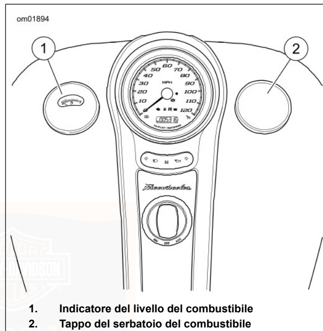
Figura 26. Serbatoio del combustibile: FLRT
