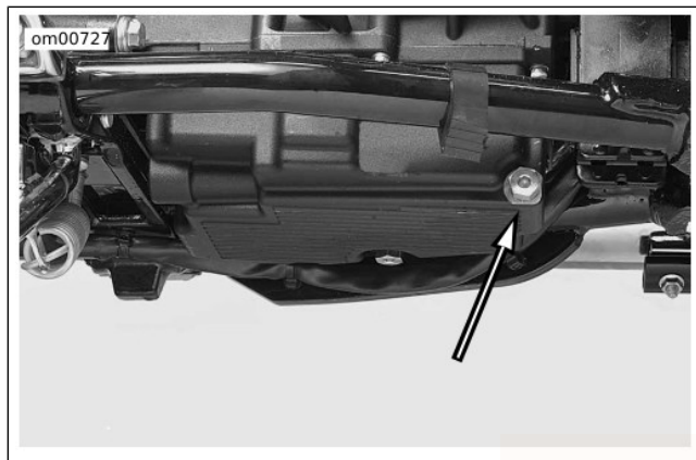
Figura 24. Tappo di scarico dell'olio motore (coppa dell'olio sotto il cambio, vista dal lato sinistro del veicolo)
