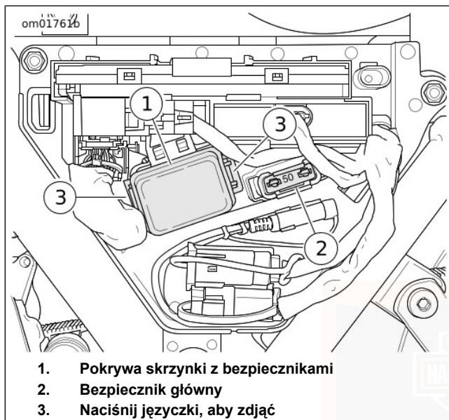
Rysunek 91. Blok bezpieczników (pod lewą pokrywą)
