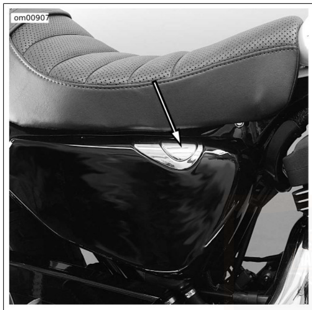
Figura 25. Posizione dell'astina di livello dell'olio: modelli Sportster
