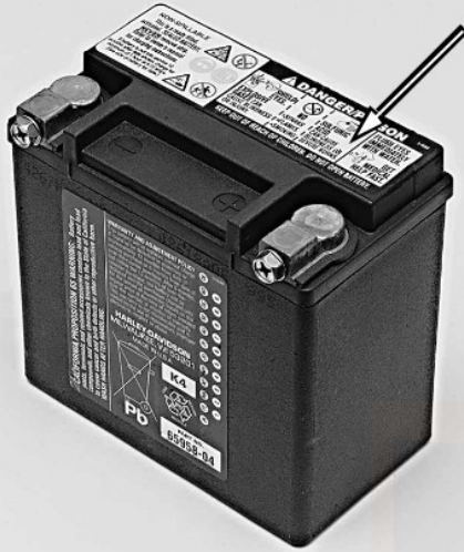
Figura 46. Etichetta di avvertenza della batteria: modelli Sportster
