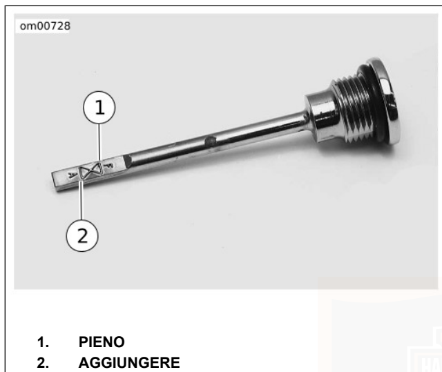
Figura 32. Tappo del rifornimento/astina di livello dell'olio del cambio
