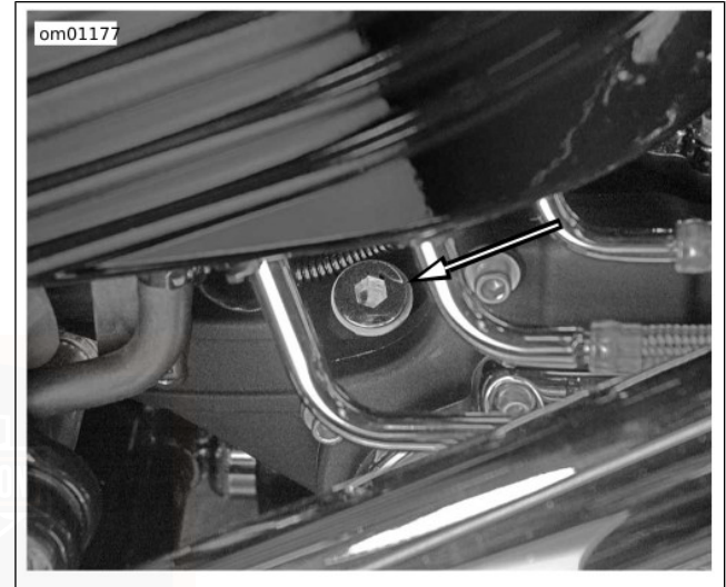
Figura 31. Tappo del rifornimento/astina di livello dell'olio del cambio (la figura ritrae il modello FXCWC)
