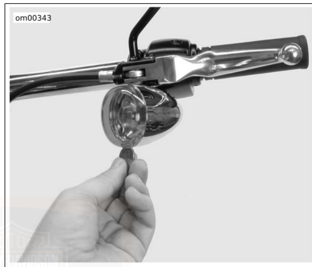
Figura 46. Tacca sulla cornice della lente SOSTITUZIONE DELLE LAMPADINE DEGLI INDICATORI DI DIREZIONE: STILE A LENTI PIATTE
