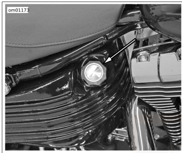
Figura 26. Posizione dell'astina di livello dell'olio (mostrata per i modelli FXCWC)
