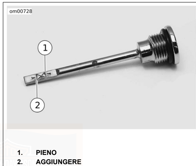
Figura 36. Tappo del rifornimento/astina di livello dell'olio del cambio
