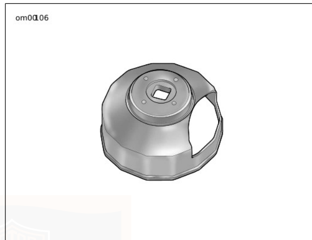
Figura 33. Estrattore per filtri dell'olio (No codice HD-44067)
