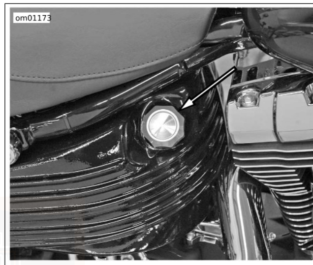
Figura 28. Posizione dell'astina di livello dell'olio: modelli FXCW/FXCWC
