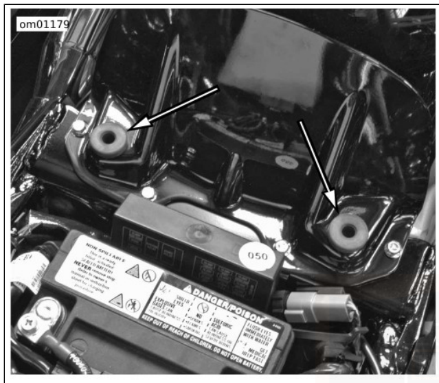
Figura 69. Occhielli di montaggio della sella: Modelli FXCW
