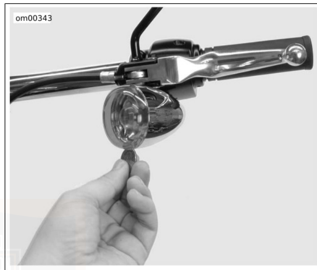
Figura 49. Tacca sulla cornice della lente SOSTITUZIONE DELLE LAMPADINE DEGLI INDICATORI DI DIREZIONE: STILE A LENTI PIATTE
