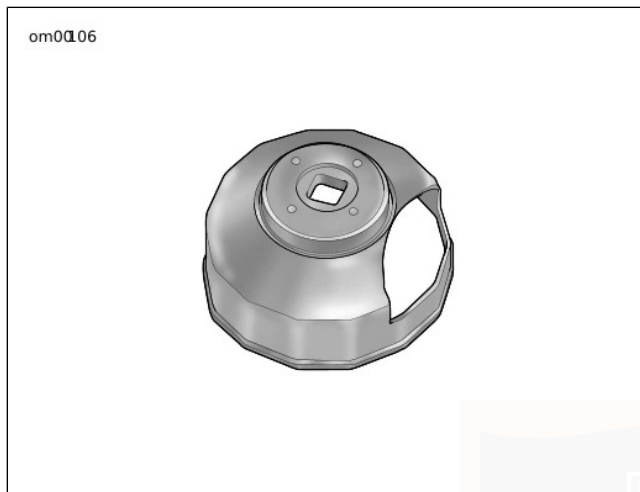
Rysunek 34. Klucz do filtra oleju (część nr HD-44067)
