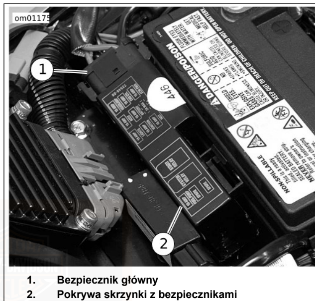
Rysunek 63. Blok bezpieczników: Modele Softail
