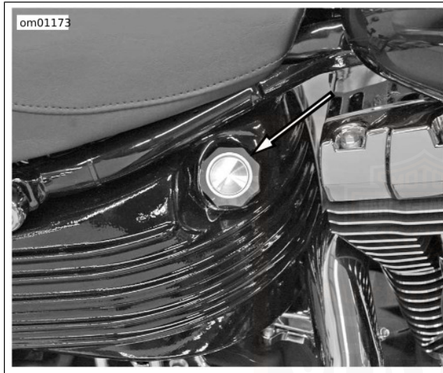
Rysunek 29. Położenie wskaźnika oleju: Modele FXCW/FXCWC
