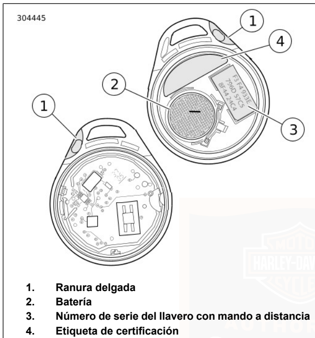
Figura 13. Batería del llavero con mando a distancia
