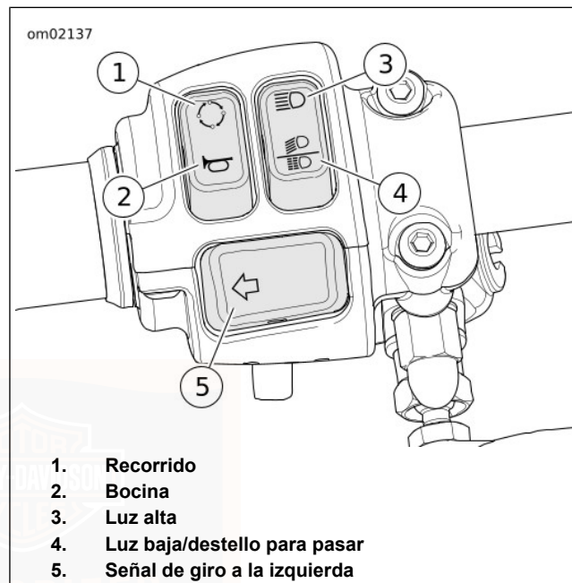
Figura 4. Módulo de interruptores del lado izquierdo
