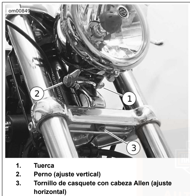
Figura 52. Ajuste del faro delantero (XL 883C y XL 1200C)
