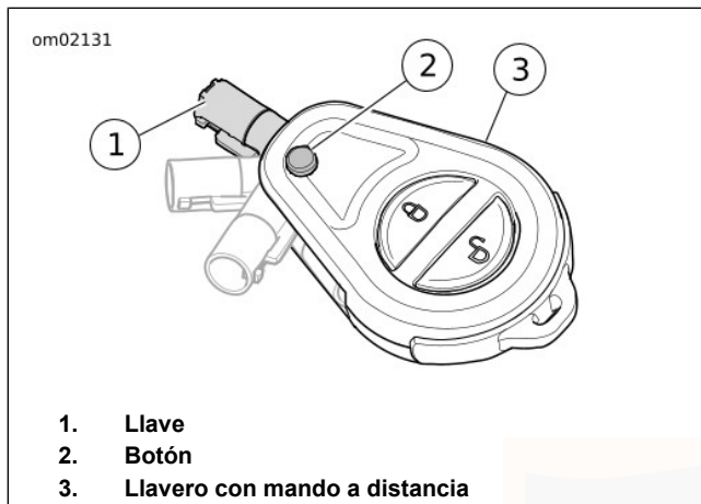
Figura 18. Funcionamiento del llavero
