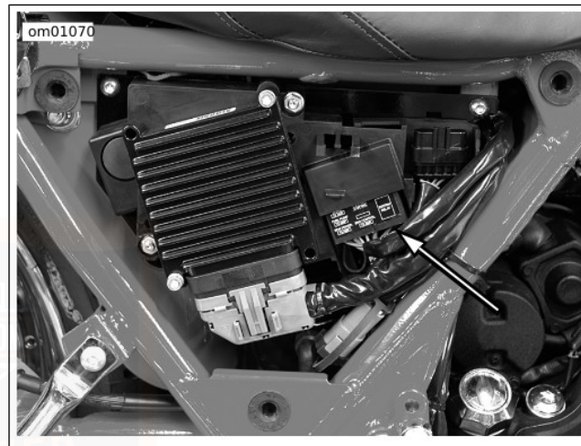
Abbildung 57. Lage des Sicherungsblocks der elektronischen Kraftstoffeinspritzung: FLHRSE3
