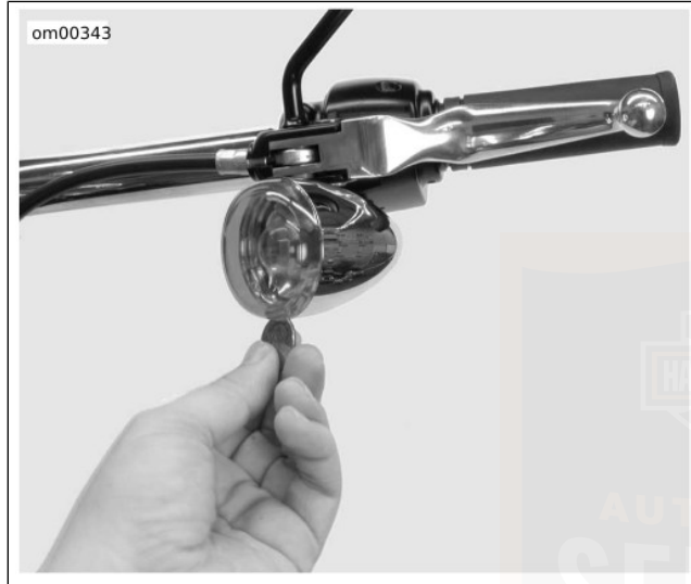
Abbildung 66. Kerbe in der Streuscheibe
