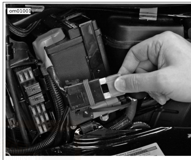
Abbildung 54. Maxi-Sicherung: 2007 Sportster-Modelle SITZ: SPORTSTER-MODELLE
