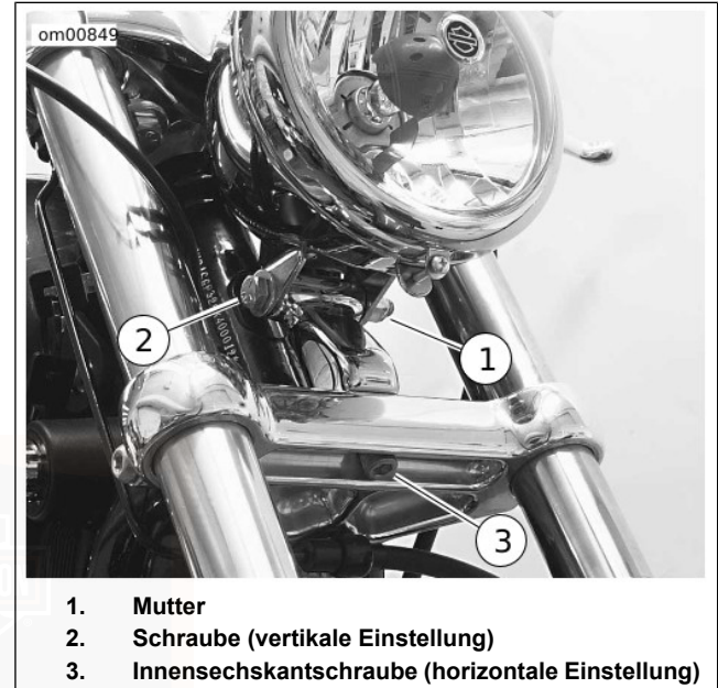
Abbildung 43. Scheinwerfereinstellung (XL 883C und XL 1200C)
