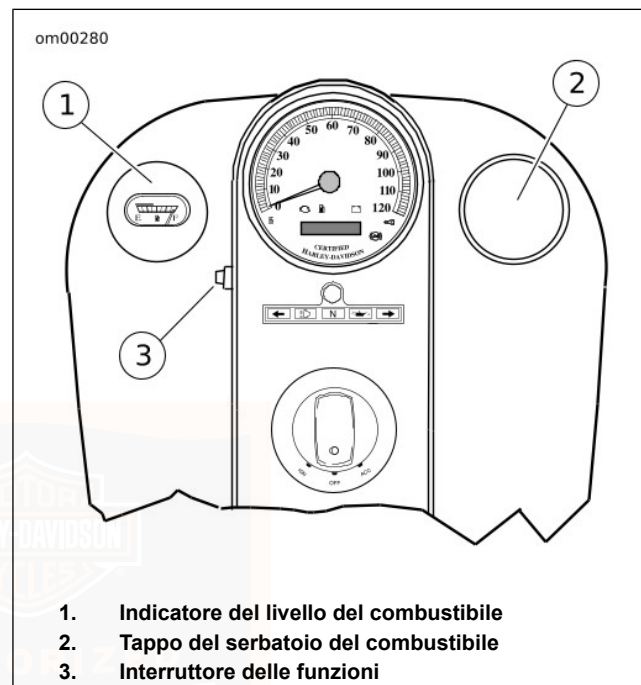
Figura 17. Serbatoio del combustibile: FLHR/FLHRC
