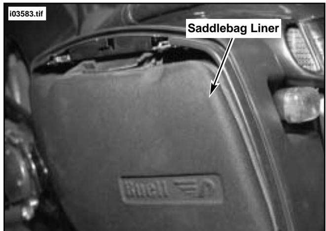
**Figure 14. Install Saddlebag Liner**
