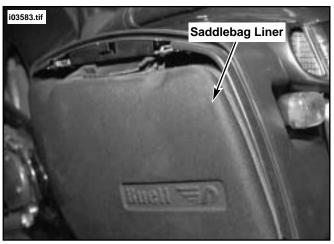
Figure 14. Install Saddlebag Liner
